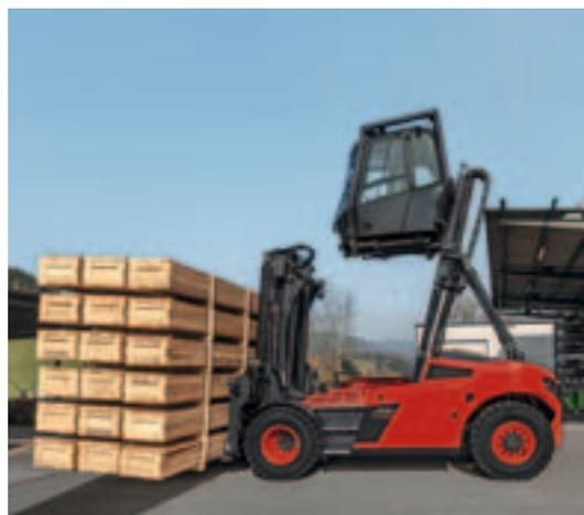
Lösung für Schwerlaststapler im Traglastbereich von zehn bis 18 Tonnen ist die optionale Hubkabine. In weniger als zehn Sekunden fährt die Fahrerkabine auf Knopfdruck stufenlos in eine Höhe von maximal 5,5 Metern. Von dort überblickt der Fahrer das Ladegut und kann in gewohnter Weise vorwärts fahren. Besonders geeignet ist die Hubkabine für das Stapeln sowie das Ein- und Auslagern schwerer Güter oder deren Ablage auf schmalen Flächen – wie beispielsweise Ladeöffnungen von Flugzeugen.
