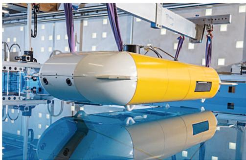
wird mit acht Batterien betrieben, die je 15 Kilogramm wiegen. Eine Batterieladung reicht für bis zu 20 Stunden Fahrzeit. Die Ladebuchst ist etwa einen Meter lang und bietet gleich mehreren Sensoren für die Erkundung des Meeresbodens Platz. In Deutschland ist das Gerät erstmals auf der Hannover Messe (25. bis 29. April 2016) zu sehen. **■** [www.fraunhofer.de](http://www.fraunhofer.de)
