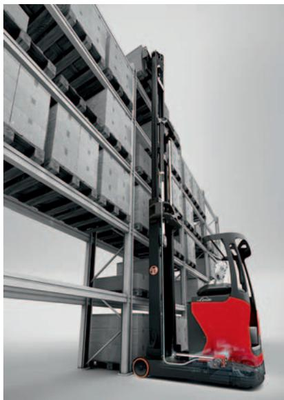
Schubantrieb. Er gleicht mit präzisen Gegenbewegungen des Schubschlittens sowohl Mastschwingungen als auch die Durchbiegung des Mastes schnell, präzise und energieeffizient aus. Damit braucht der Fahrer eines Schubmaststaplers mit DMC nicht mehr auf ein Auspendeln der Last zu warten, sondern kann Lastträger deutlich schneller und sicherer einlagern. Durch das lotrechte Anheben der Last ergibt sich zudem ein deutlich geringeres Risiko für mögliche Beschädigungen von Waren oder Regalen.
