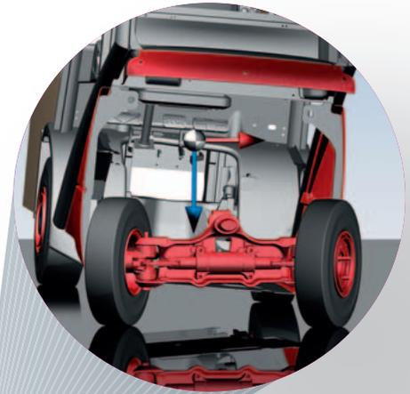
→ Bisher wurde die (statische) Kippsicherheit von Gegengewichtstaplern durch den statischen Standsicherheitstest nach ISO 22195 geprüft. Dies erfolgte mit stehendem Gefährt auf einer Kippbühne. In der Praxis hat sich aber gezeigt, dass es vermehrt seitliche Kippunfälle bei Leerfahrten von Gabelstaplern gegeben hat. Hieraus ist die Anforderung eines dynamischen Standsicherheitstests gewachsen.
