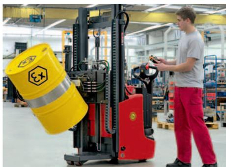
Anbaugeräten, um Fässer greifen und kippen zu können. Eine erste Variante mit kombiniertem Greif- und Kippanbaugerät wurde für ein Chemieunternehmen konzipiert. Es kommt in der Ex-Schutzzone 1 zum Einsatz und kann geschlossene Fässer mit Spundöffnung und einem Durchmesser von 300 bis 600 Millimeter aufnehmen, transportieren und zwischen null und 180 Grad schwenken. Eine zweite Ausführung des Ex-geschützten Fasskippers wurde
