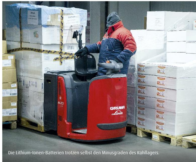
Die Lithium-Ionen-Batterien trotzen selbst den Minusgraden des Kühlagers.
